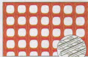
呼称 N-523 網目の大きさ(ピッチ): W7.5mmxL7.5mm サイズ(幅x長さ): 100cmx30m 色: オレンジ 主材料: EVA
